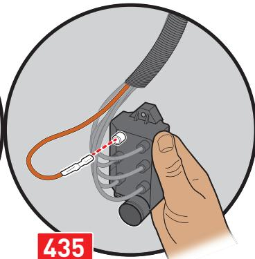
Вставить провод (проводы) в трубу, затем зафиксировать их к модулю зажигания.
