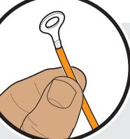
⚠ **ТОЛЬКО 435 МОДЕЛИ:** Кольцевой разъем должен быть надежно прикреплен к коллектору с помощью винта.
