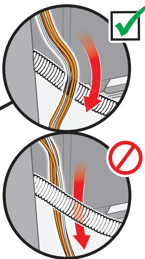
⚠ Необходимо прокладывать провода снаружи гофрированной газовой линии.
